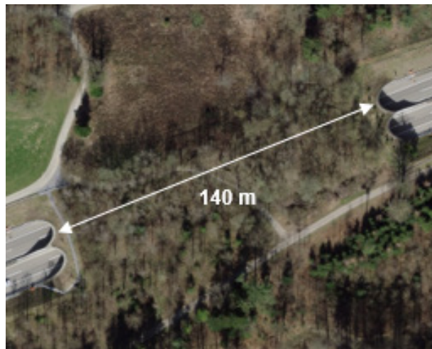
Pont biologique du Asp Holz, près de Wigoltingen (TG), qui permet de franchir l'A7. Il présente une largeur de 140 m et a été achevé en 1992. Vue aérienne et détail: map.geo.admin.ch
